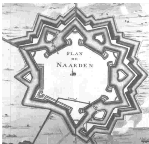
Fig. 6: De plattegrond van de vesting Naarden, zoals deze eruit zag na de modernisering in de jaren 1676-1685. Het verschil tussen de twee vestingbouwkundige systemen, die bij dit project zijn toegepast, springt duidelijk in het oog. Fragment uit een gravure van P. Mortier, eind zeventiende eeuw (Vestingmuseum Naarden).
